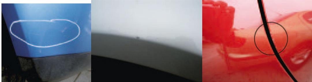
Ogrebotine koje su samo površinske i mogu da se uklone poliranjem, kao i oguljenja, posebno na ivicama, koje mogu da se otklone stručnim potezom četkicom.
