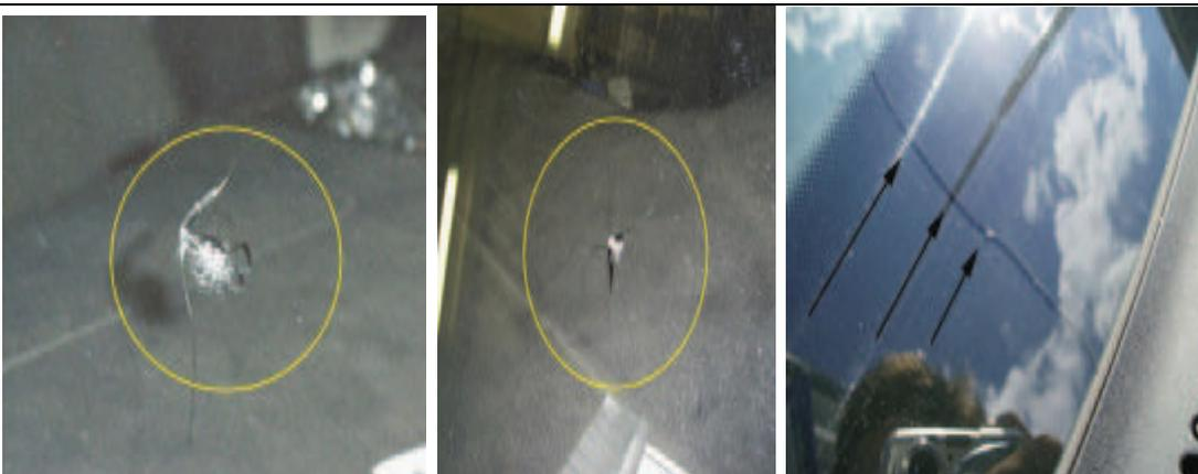
Vetrobranska stakla sa pukotinama, naprsnućima i drugim oštećenjima neprihvatljivim pri tehničkom pregledu.
