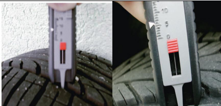
Pneumatici koji nisu jednostrano istrošeni, nemaju oštećenja i pružaju potrebnu bezbednost u saobraćaju, te imaju propisanu minimalnu dubinu profila od 3 mm.
