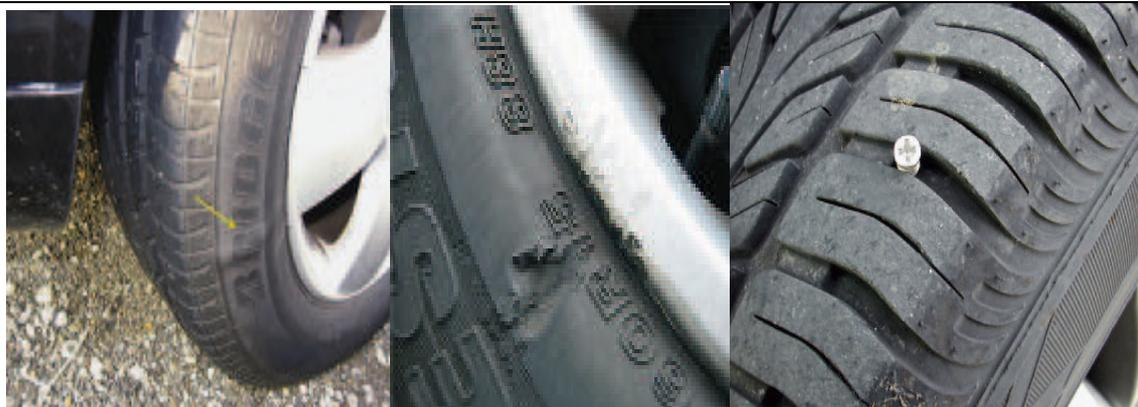
Pneumatici koji su oštećeni (ispupčenja, zaseci ...), ili su jednostrano istrošeni, ili nisu više bezbedne za saobraćaj, te nemaju dubinu profila ispod propisane minimalne dubine profila od 3 mm. Kod montiranih zimskih pneumatika moraju se prikazati originalne felne sa odgovarajućim letnjim pneumaticima.
