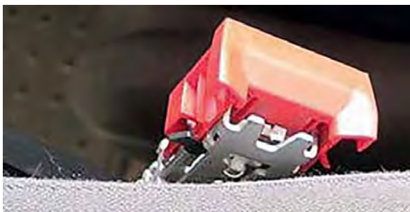
Oštećen završetak sigurnosnog pojasa
