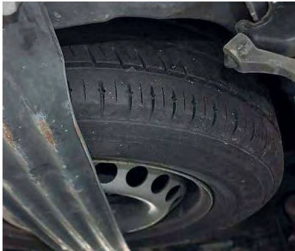
Rezervni točak montiran ispod vozila
