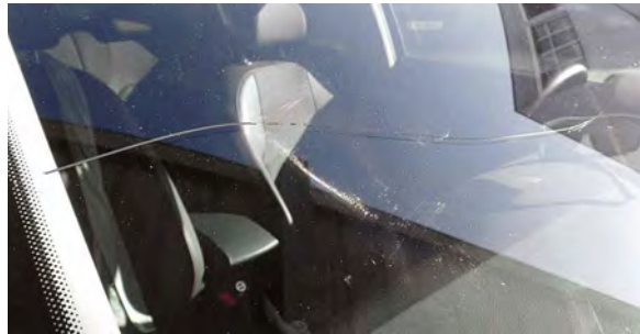
Pukotina na vetrobranskom staklu
