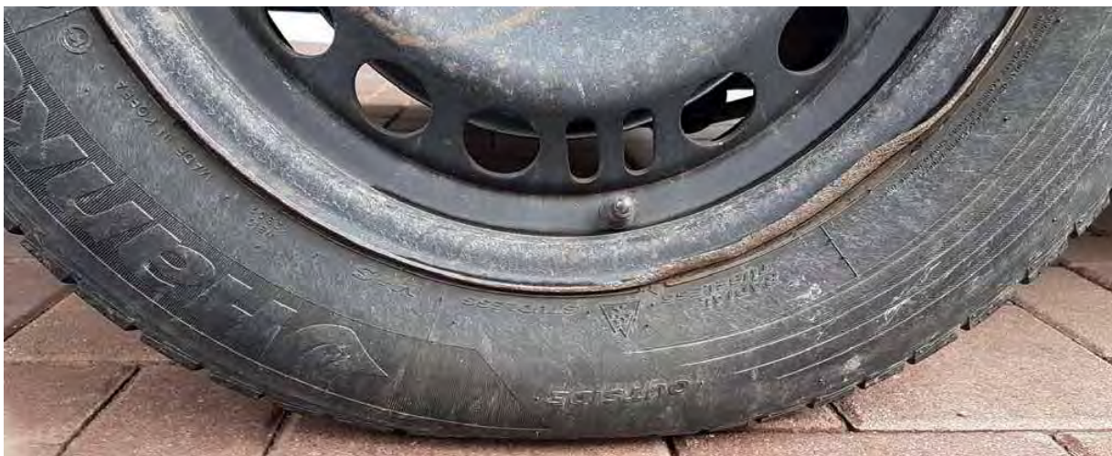
Oštećen čelični felna
