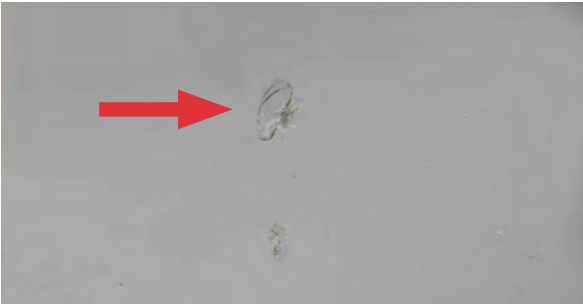
Loše sanirano oštećenje od kamenčića na vetrobranskom staklu
