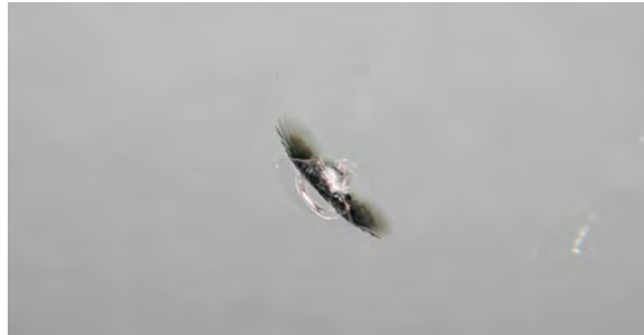
Pukotina u obliku krila pčele na vetrobransko
