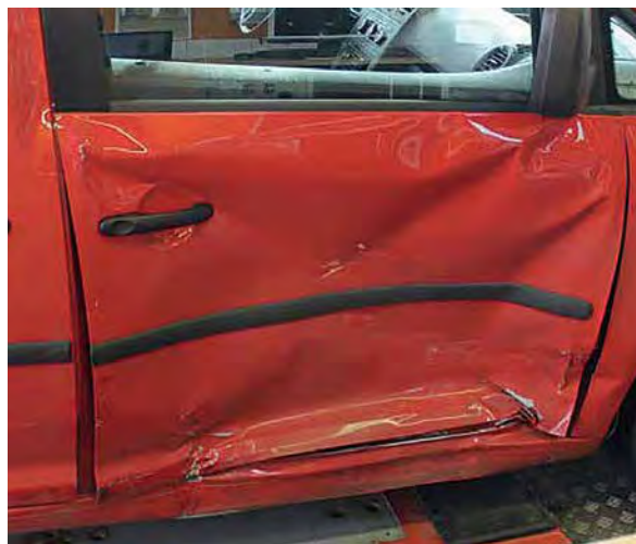
Veća oštećenja na području vrata
