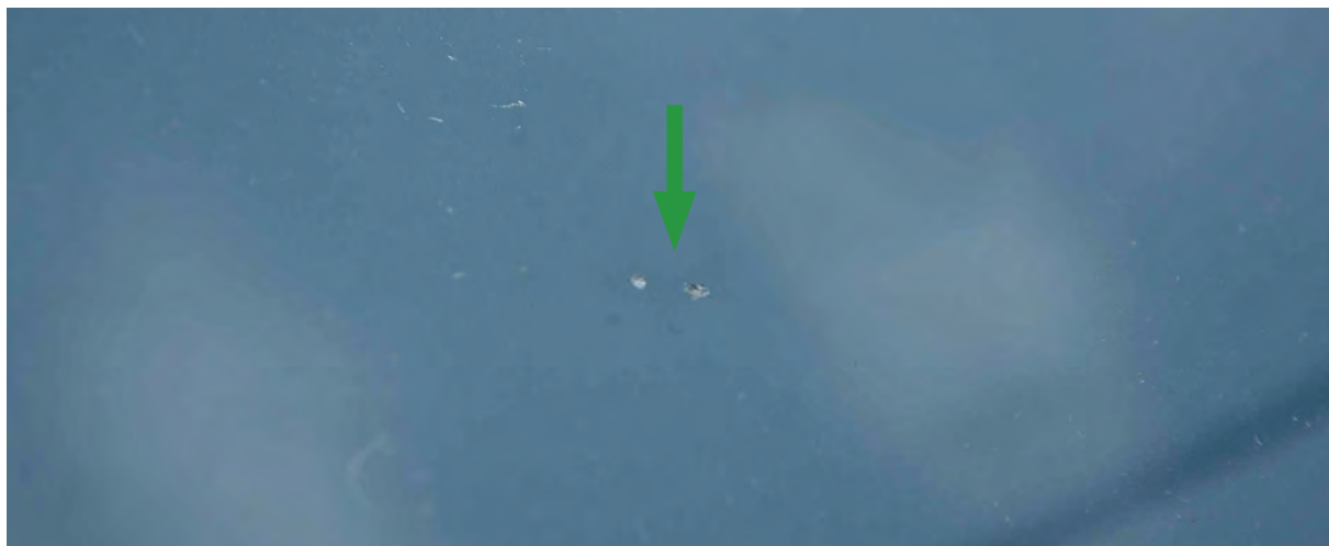
Malo oštećenje od kamenčića na vetrobranskom staklu
