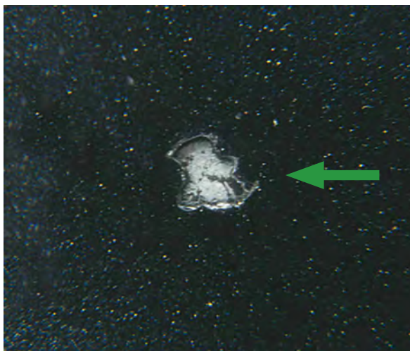
Oštećenje od kamenčića < 3 cm
