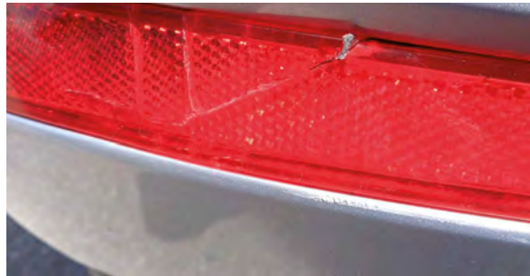
Polomljeni manji delovi stakla
