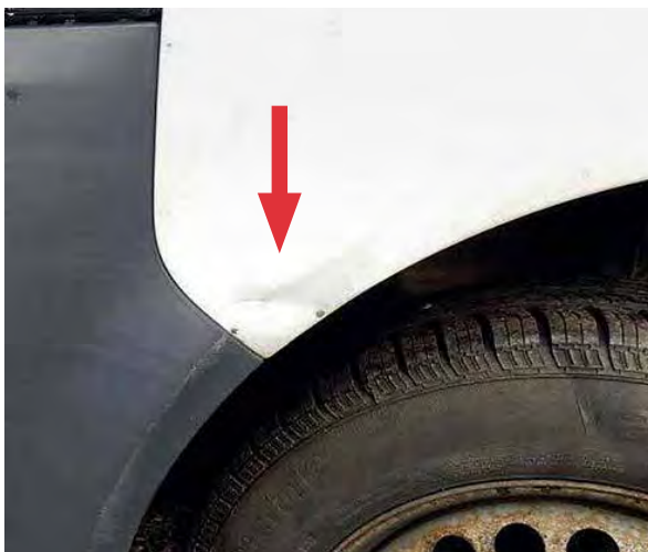
Jako oštećen blatobran
