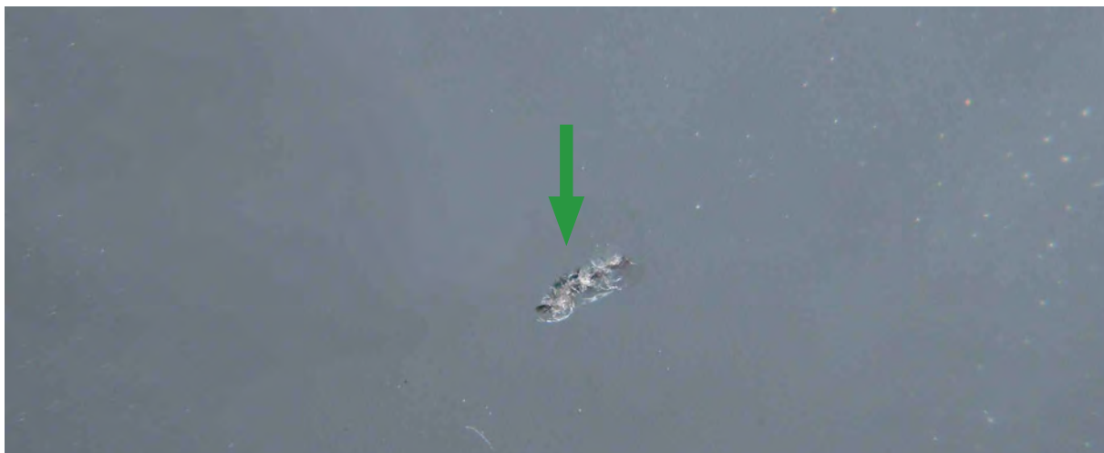
Blaga ogrebotina na vetrobranskom staklu
