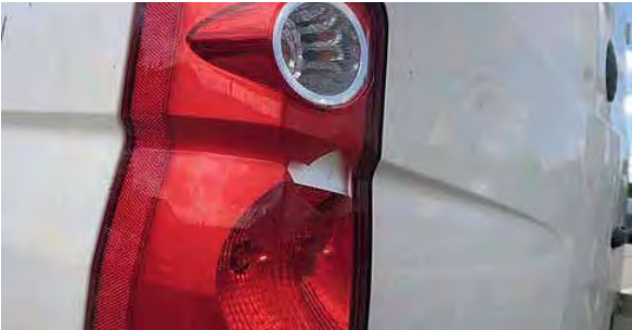
Pukotina na zadnjem svetlu
