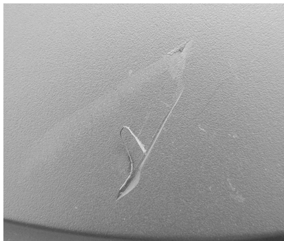
Oštećen plastični deo
