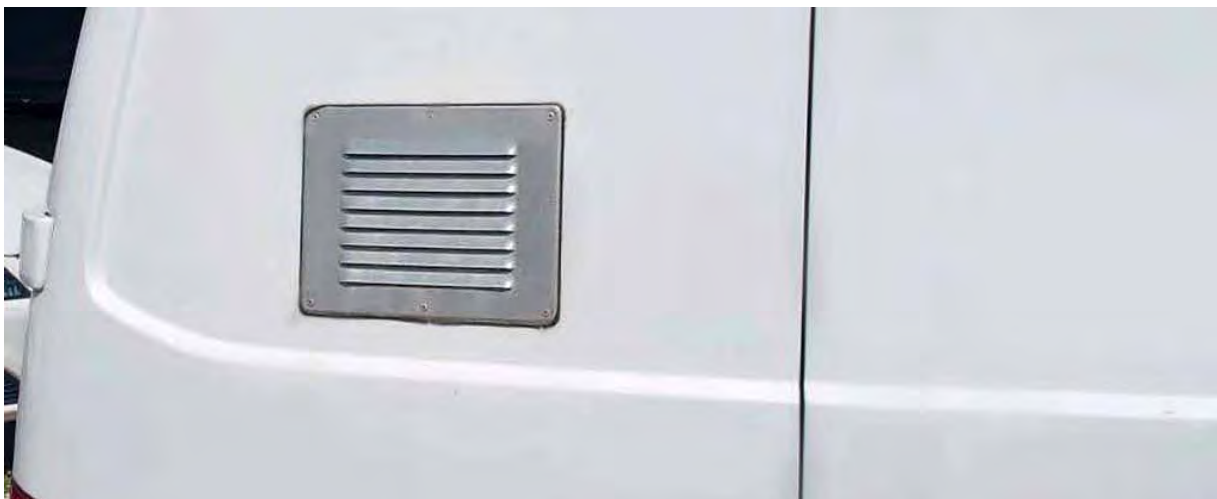
Ugradnje na karoseriji koje nisu odobrene od strane
