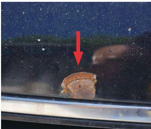
Veliko oštećenje od kamenčića sa korozijom
