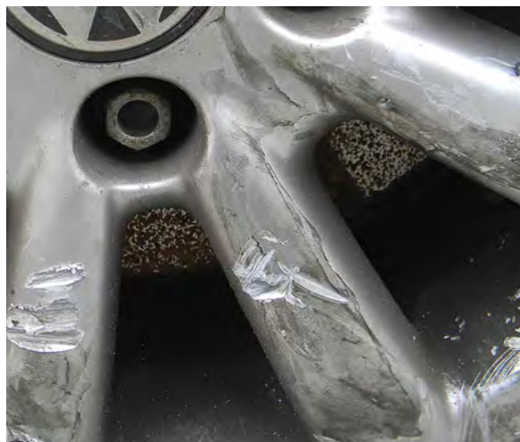
Aluminijumska felna znatno oštećena
