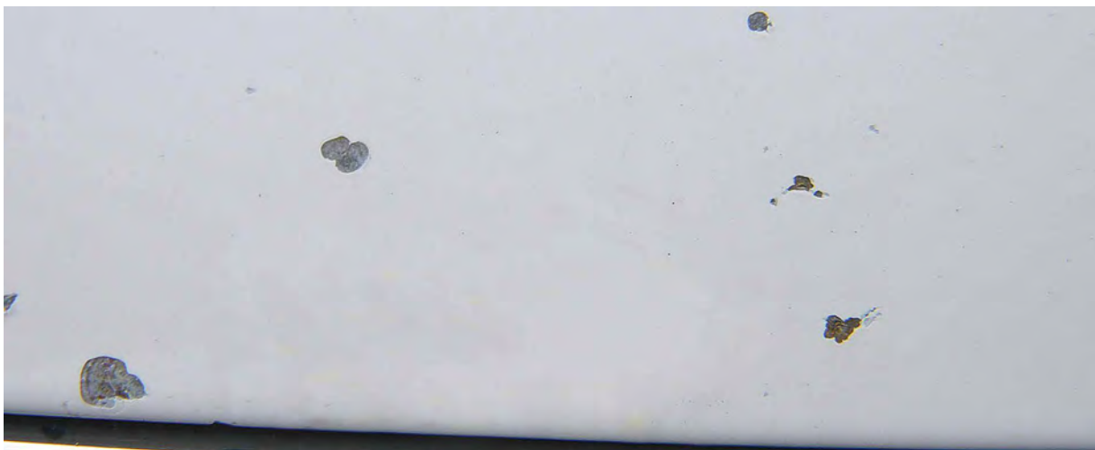
Više oštećenja od kamenčića na površini 10 × 10 cm
