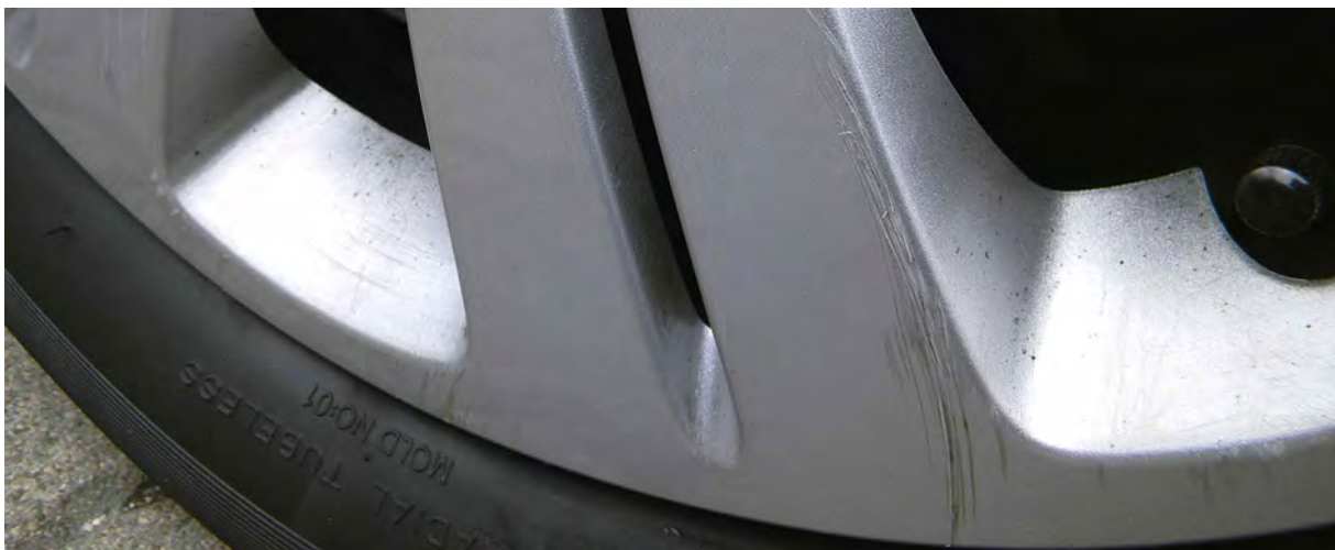
Ratkapna sa izraženim ogrebotinama
