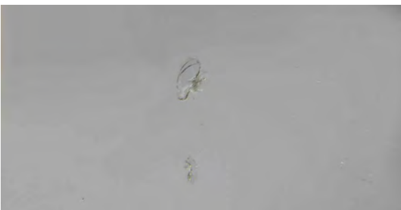
Loše popravljeno oštećenje od kamenčića na vetrobranskom staklu
