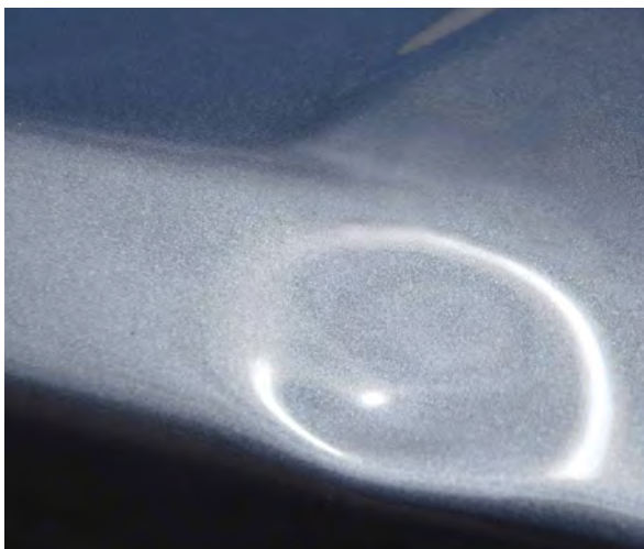
Veliko udubljenje prečnika veće od 2 cm
