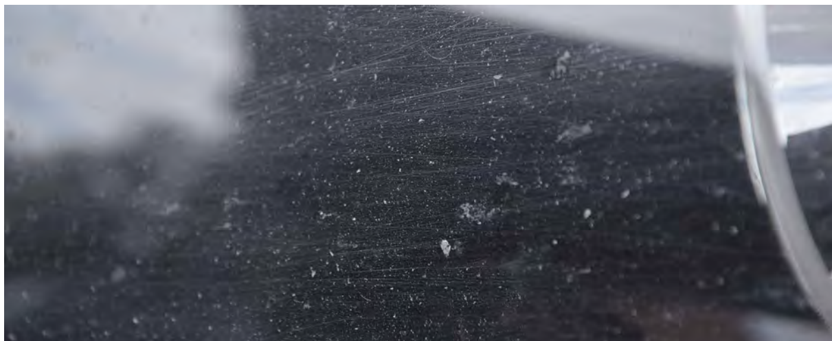
Manja oštećenja od kamenčica na manjim staklenim delovima
