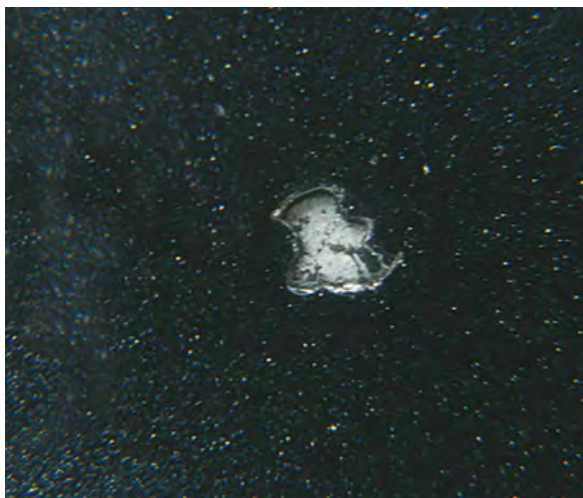
Oštećenje od kamenčića manje od 2 cm
