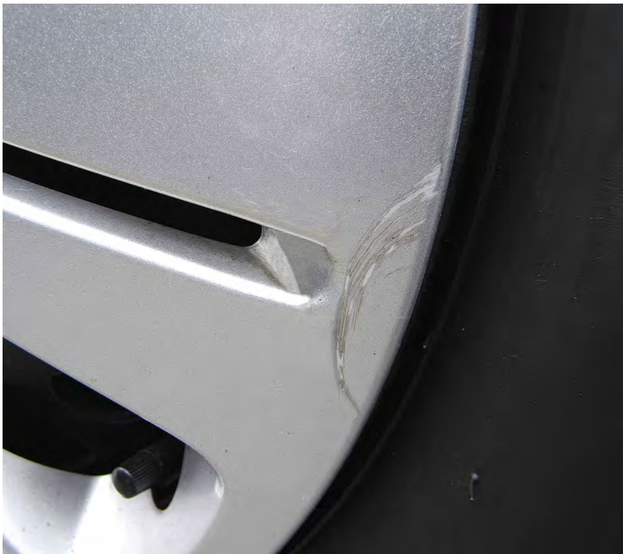
Manje lokalno oštećenje
