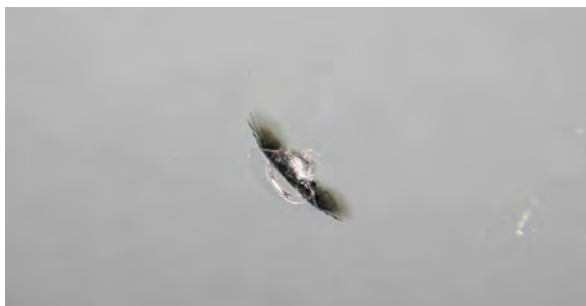
Pukotina u obliku pčelinog krila na vetrobranskom staklu
