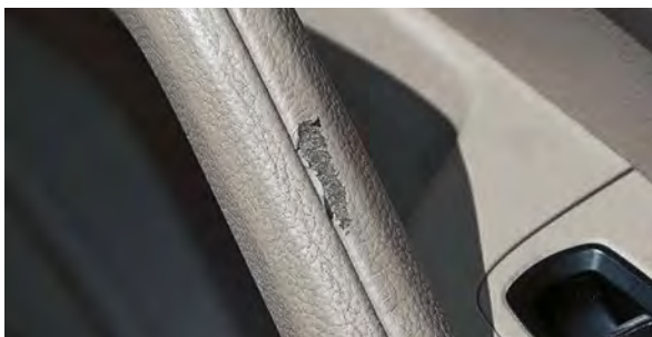
Oštećena obloga vrata
