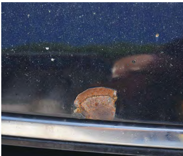
Velika oštećenja od kamenčića sa znakovima rđe
